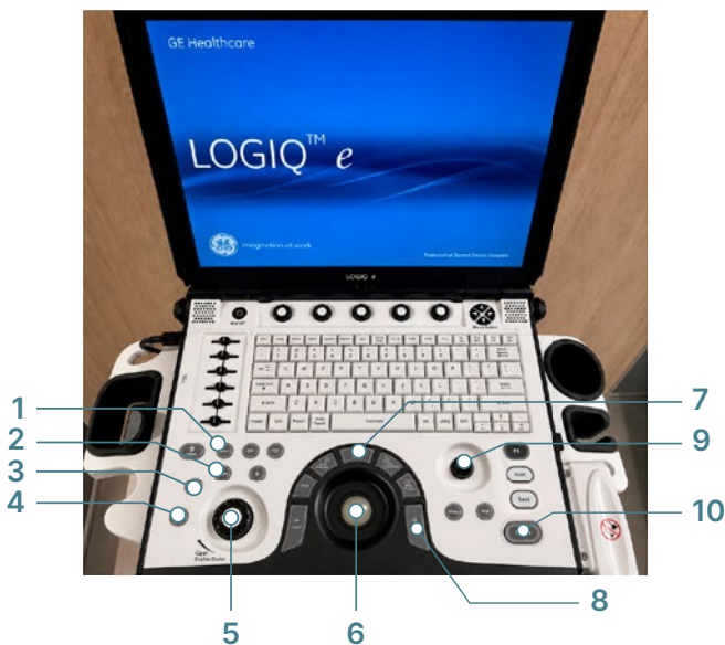
Рис. 5. Основные элементы управления аппаратом для ультразвукового исследования (могут отличаться у различных моделях и производителях): 1 – клавиша выбора датчиков для исследования; 2 – включение цветового доплера; 3 – клавиша включения импульсно-волнового доплера; 4 – клавиша включения М-режима; 5 – регулятор яркости изображения; 6 – трекбол для перемещения курсора по экрану; 7 – клавиша включения измерений; 8 – клавиша подтверждения выбора; 9 – регулятор глубины изображения; 10 – клавиша заморозки изображения
