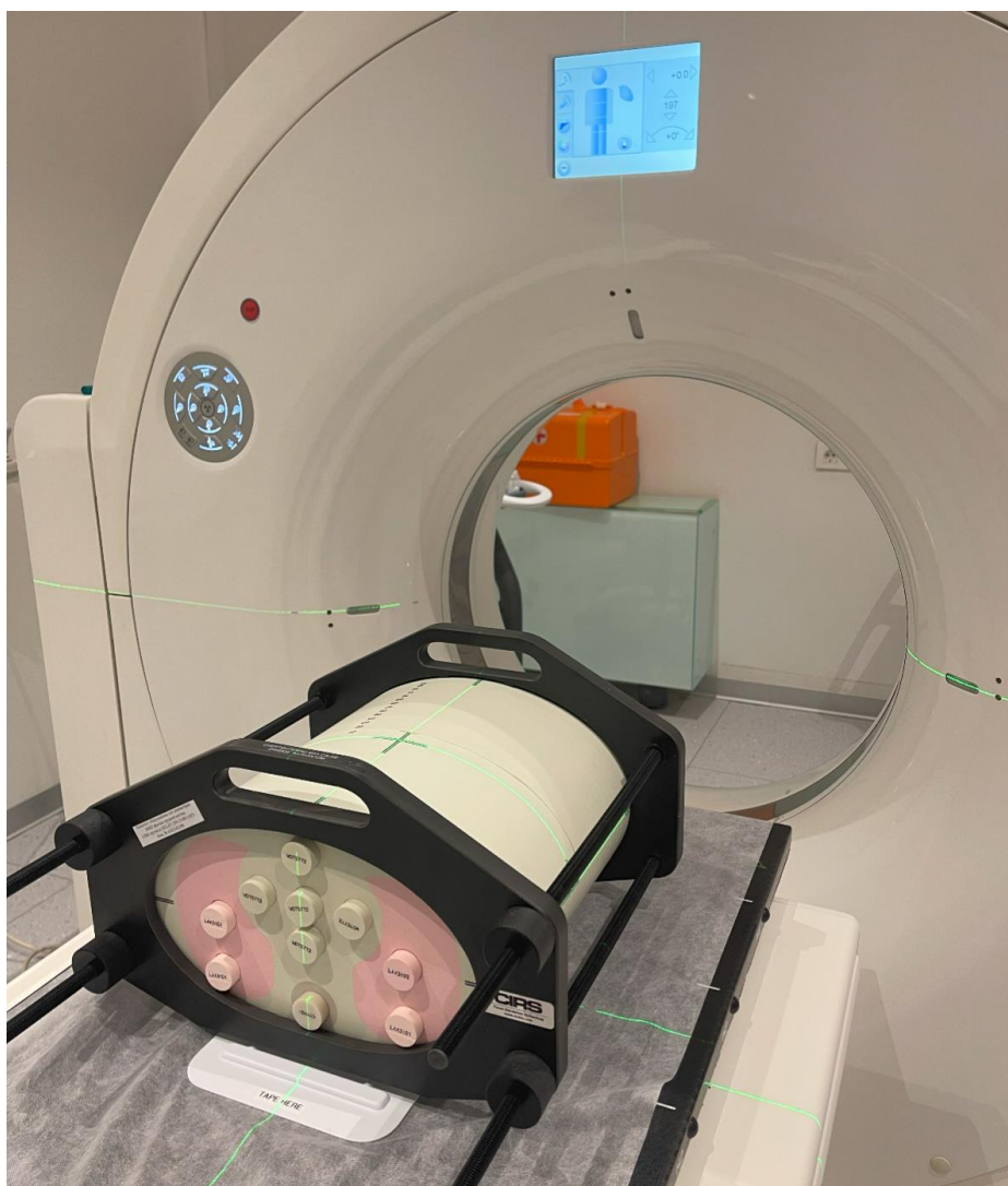
Рисунок 2 – Общий вид фантома при сканировании на КТ
