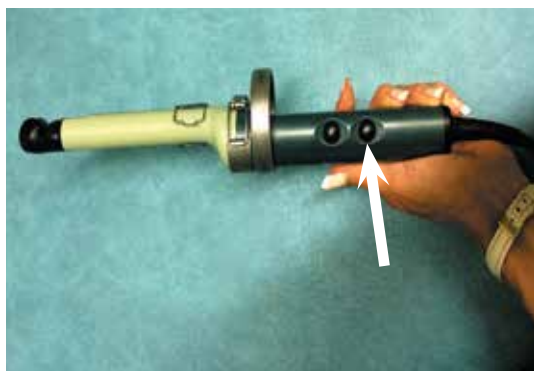
Рис. 8. Расположение кнопки переключения режима поперечного сканирования на трансректальном УЗ-датчике
