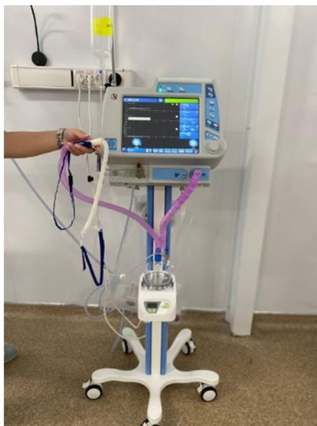
**Рисунок 15.** Пример собранного контура для ВПО на аппарате ИВЛ «Авента-М»
