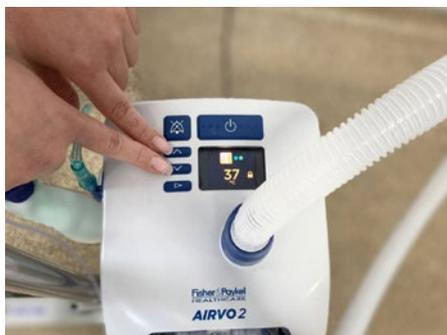
**Рисунок 12.** Одновременное нажатие (VΛ) в течение 3 сек. позволяет изменить параметр
