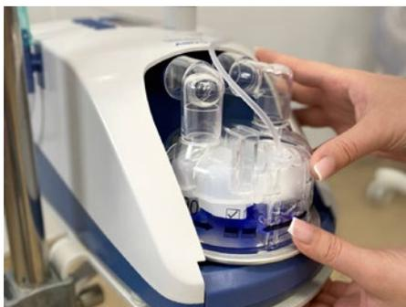
**Рисунок 6.** Установка камеры увлажнения на нагреватель
